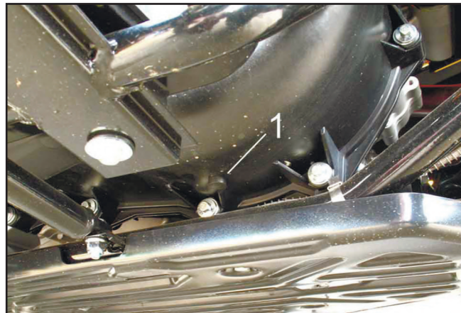
1. Vypouštěcí šroub variátoru.
